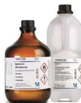
Figura 3. Frascos de productos químicos con las etiquetas del GHS, que permiten conocer, clasificar su peligrosidad y por tanto como manejarlas. <sup>4</sup>
